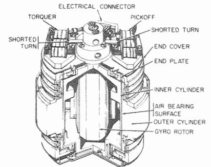
Figure 2-18. AB-5 Gyroscope
