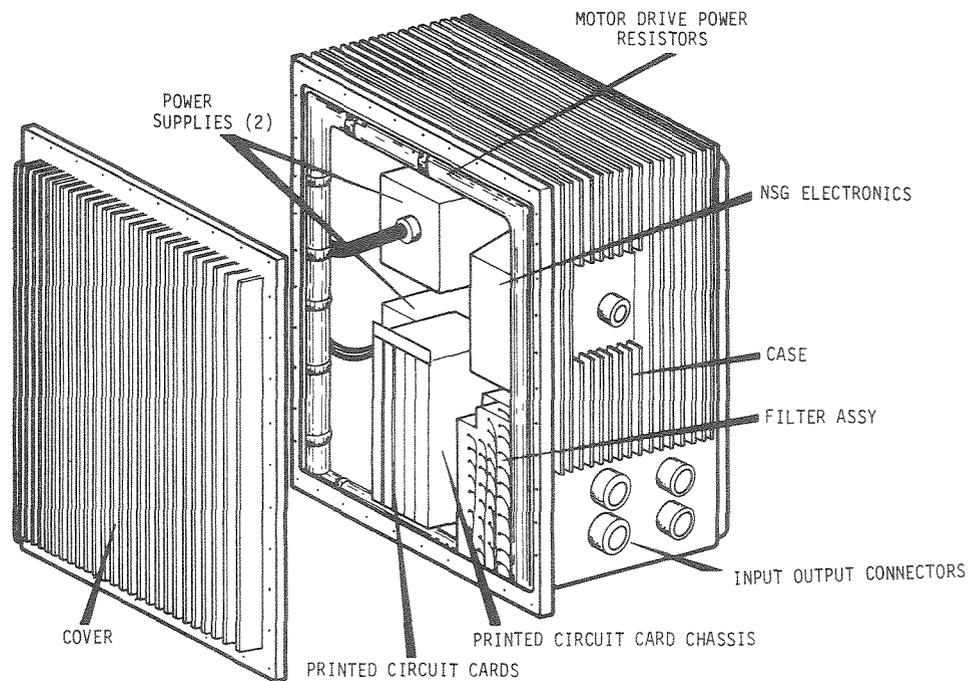
*Figure 11-8. Electronics Unit*
